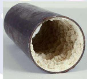
Incrustaciones en tubería por la presencia de varios parámetros: dureza, alcalinidad, solidos disueltos, temperatura
