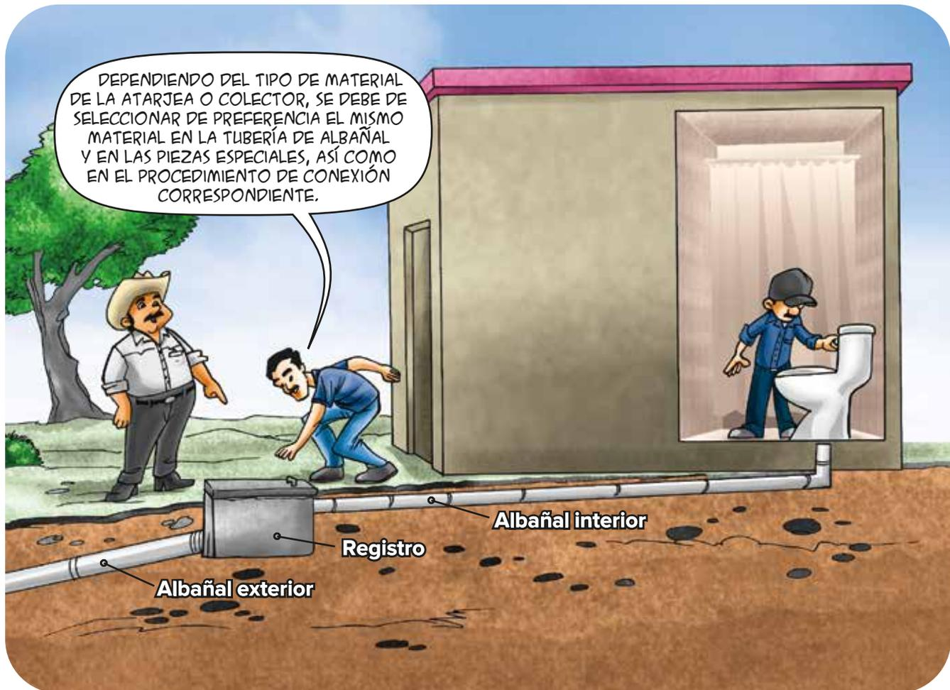
► Fig. 3. Instalación de una descarga domiciliaria.
