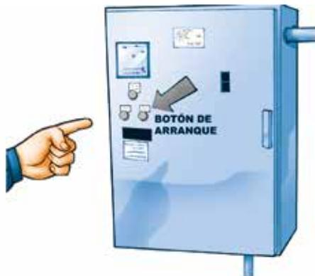
**A)** El equipo se arranca o se para accionando el botón correspondiente en el arrancador que se encuentra dentro de la caseta de control.
